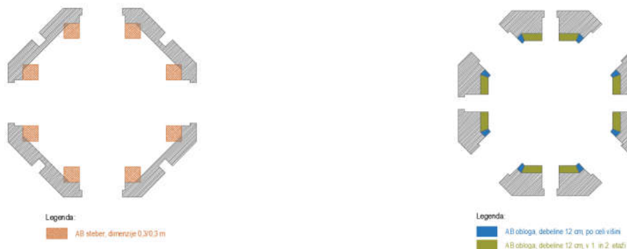
Slika 3: Stolp, shema protipotresnih utrditvenih ukrepov: varianta z ojačitvenimi stebri (levo), varianta z armiranobetonsko oblogo (desno)
